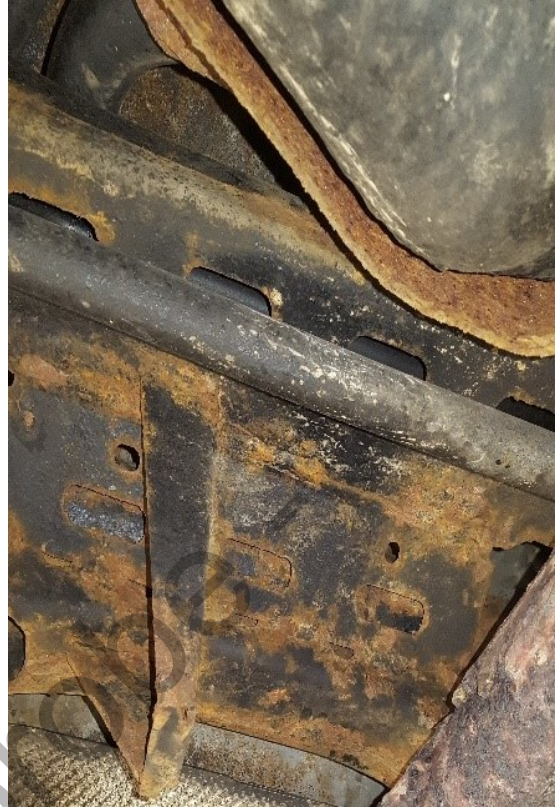
Abbildung 4: Oberflächenkorrosion am Unterboden
