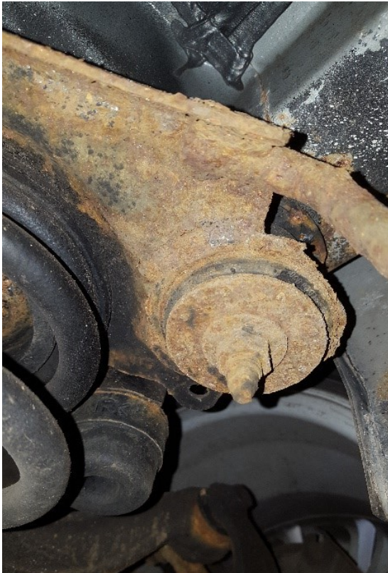
Abbildung 3: Oberflächenkorrosion am Hinterachskörper
