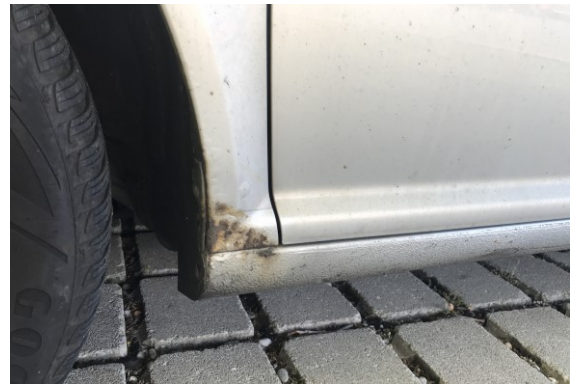
Abbildung 2: Beginnende Korrosion an der Radabdeckung
